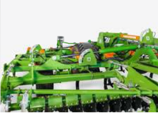
Arbeitstiefenanzeigen der drei Werkzeugeinheiten
