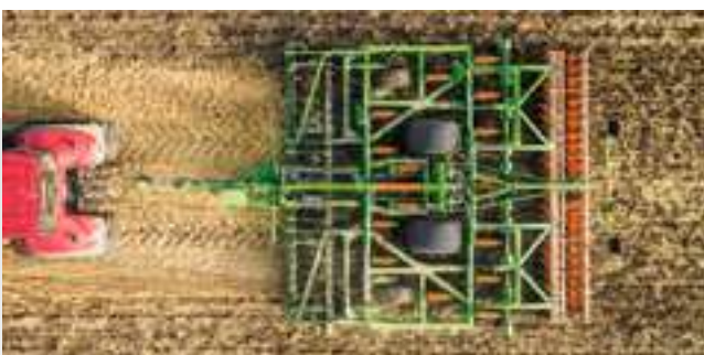
Hinter jedem Rad läuft ein Zinken zur Radspurlockerung
