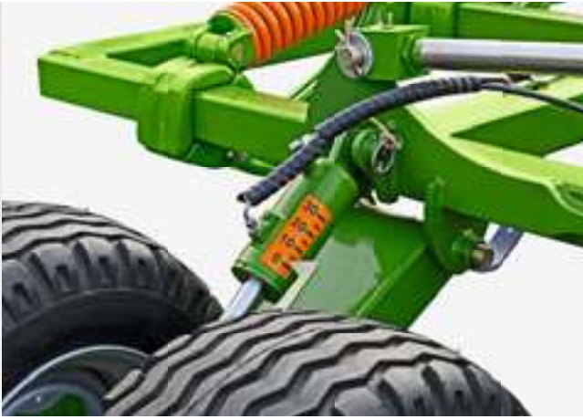
Skala der hydraulischen Arbeitstiefenverstellung des Zinkenfeldes
