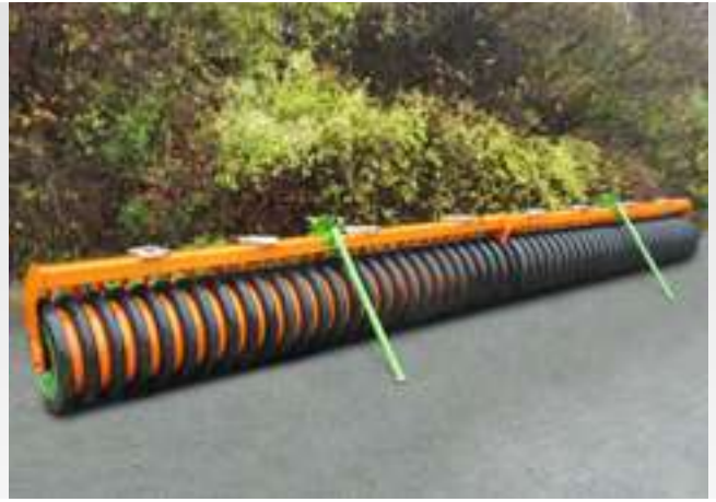
❗ „Mittels der geschraubten Klammern lässt sich die Walze recht einfach demontieren für nasse Bedingungen oder eine grobe ‚Herbstfurche‘.“ (traction – Arbeitsprobe AMAZONE Cenius 5003-2TX Super · 3/2016)
