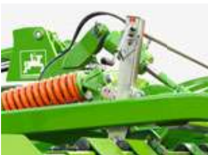
Spindeln zur zentralen Einstellung der Einebnungseinheit am Cenius-2TX
