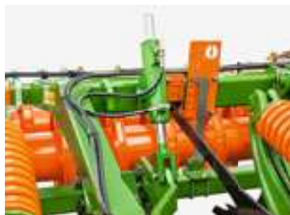
Zylinder zur Tiefeneinstellung der Einebnungseinheit
