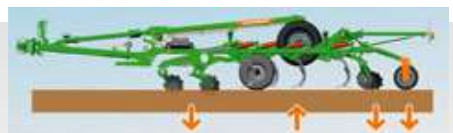
Arbeiten ohne Zinkenfeld
